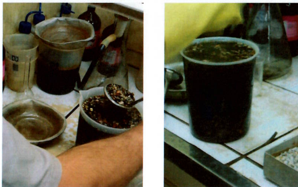
Figura 16 - Separação em líquido denso com detalhes da retirada do produto flutuado
